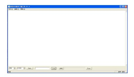
步骤 2. OPEN 打开 RTU 设备对应的串口和点击"Load"选择需要升级的程序 BIN 文件,点击 "DOWN"功能按钮,准备开始升级程序
