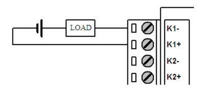
模拟量输入接线图: (电流, 4-20mA)
