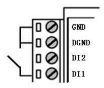
开关量输入接线图: (湿接点)
