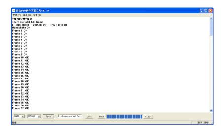
步骤 4. RTU 程序升级完成后,提示"DownLoad OK",说明程序烧写成功
