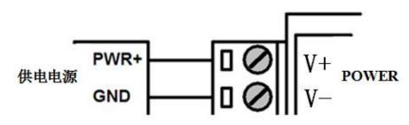
设备连接好供电电源后,直接上电即可工作。
