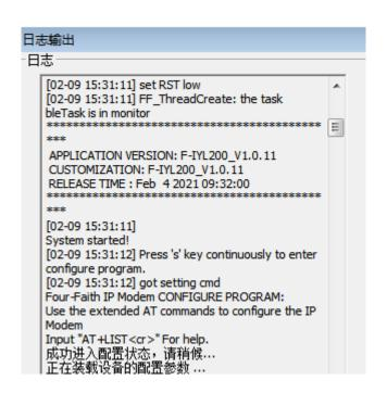
7. 至此,设备已经成功进入配置状态,可以用扩展 AT 命令对设备进行参数配置了。
